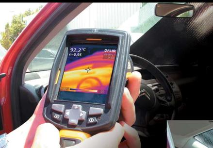
Medido con un aparato de termografía en el interior del automóvil a las 15 horas aproximadamente con una hora de exposición solar, la temperatura alcanzada asciende a 92,2°C (medido junto al salpicadero)
