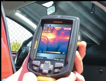
Medido con un aparato de termografía en el interior del vehículo, con un parasol colocado en el cristal, a las 15 horas, con una hora de exposición solar, la temperatura baja aproximadamente 52° C (medido junto al salpicadero).
